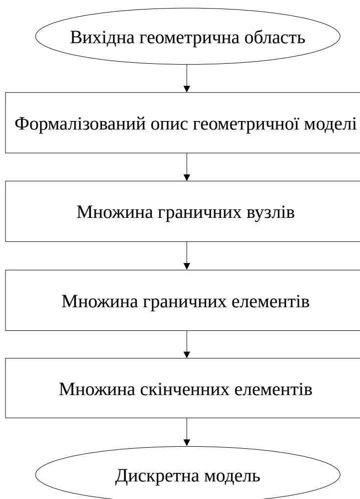
Рис. 2.2 – Типова схема побудови дискретної моделі
